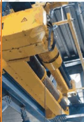
Стандартное отключение при перегрузке даже без тросовой подвески благодаря плавающему механизму.
