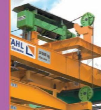
Четырехточечный захват для груза обеспечивает транспортировку почти без раскачиваний и скручивания канатов, таким образом, обеспечивая ее безопасность.
