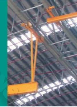
оснастила крановые системы системами питания, установленными вдоль 76-метровых крановых путей. Для предотвращения коррозии при длительной транспортировке кранов морем в Африку они были обработаны высококачественным покрытием.
