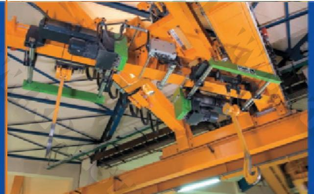
Крановый мост был поднят на концевые ходовые тележки, чтобы увеличить эффективную высоту крюка. Для предотвращения столкновений с соседним краном были установлены световые барьеры.
