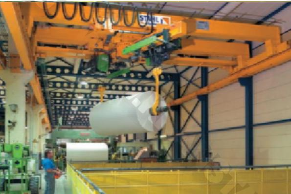
Погрузочные крюки двух канатных талей имеют специальную удлиненную конструкцию, чтобы осуществлять погрузку-разгрузку рулонов бумаги без необходимости использовать нестандартную стрелу.
