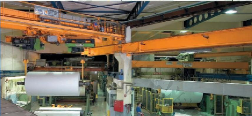
В конце кранового пути кран движется в зону кранового пути соседнего крана, работающего под ним. Компания «STAHL CraneSystems», совместно с оператором и Ассоциацией по страхованию ответственности работодателей, разработала концепцию безопасности для обеспечения безопасного выполнения работ.
