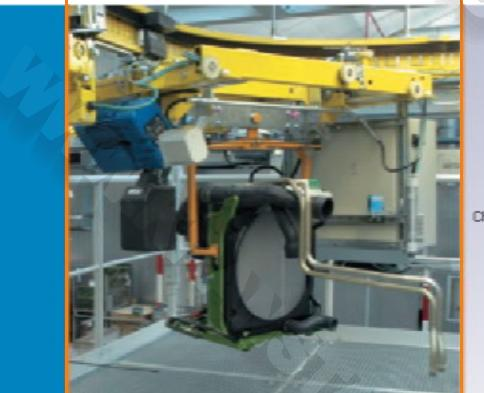
В зоне погрузки груз центрируется под монорельсом. Для сборки радиаторов таль может поворачиваться под прямым углом к подкрановому пути на свободно перемещаемой скользящей раме, так как тракторы имеют разные колесные базы.
