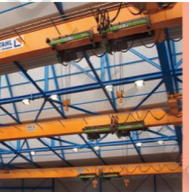
Смещенная конструкция крановой балки компании «STAHL CraneSystems» позволила выработать максимально эффективный путь крюка, несмотря на очень низкий потолок. Дополнительная подвесная тележка в центре позволила построить пролет длиной 51 м.
