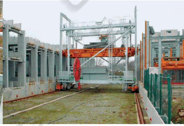
Специальные сверхгибкие проволочные канаты с коэффициентом запаса прочности 10:1 используются как грузоподъемные элементы.
