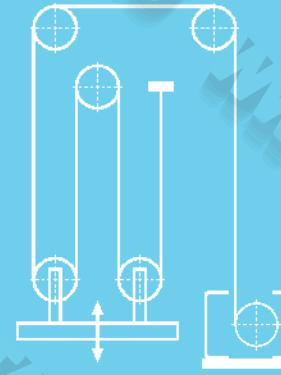
Как уже упоминалось, благодаря установке четырех канатных талей на земле они легкодоступны для технического обслуживания и любого необходимого ремонта. Тали, производимые компанией «STAHL CraneSystems», конечно же, разработаны таким образом, что двигатель находится снаружи барабана. Это обеспечивает легкий доступ к тормозному механизму и кратковременность простоев, необходимых для технического обслуживания.
