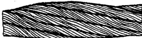
Рис. 12. Выдавливание проволок прядей: a — в одной пряди; б — в нескольких прядях
