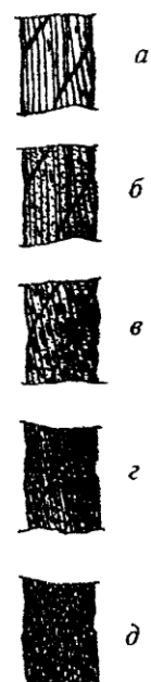
Рис. 6. Поверхностная коррозия проволок каната крестовой свивки: a — начальное окисление поверхности; б — общее окисление поверхности; в — заметное окисление; г — сильное окисление; д — интенсивная коррозия
