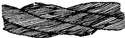
Рис. 1. Обрывы и смещения проволок каната крестовой свивки
